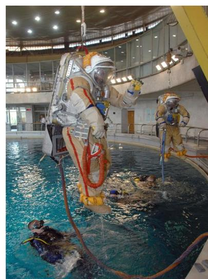
Гидролаборатория – сложное гидротехническое сооружение, содержащее большой комплекс технологического оборудования, специальных систем, аппаратуры и механизмов. Основную центральную часть здания гидролаборатории занимает огромный цилиндрический резервуар (диаметр 23 метра, высота 12 м), заполненный 5000 тонн воды с температурой около 30 градусов.
